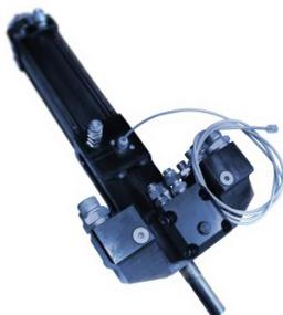
L-förmiger Cannon FPL SR PU-Hochdruck-Mischkopf mit Überwachungssensoren für Strömungs- und Verarbeitungsparameter zur vorausschauenden Analyse für vorbeugende Wartungen. Foto: Cannon Group
